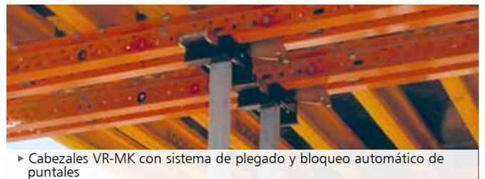
▶ Cabezales VR-MK con sistema de plegado y bloqueo automático de puntales
